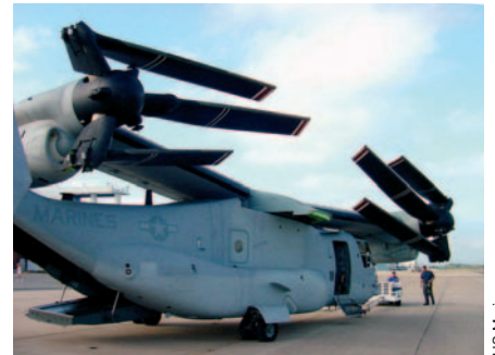
Вверху: MV-22B №22 в конфигурации для размещения в корабельном ангаре – крыло и лопасти винтов сложены
