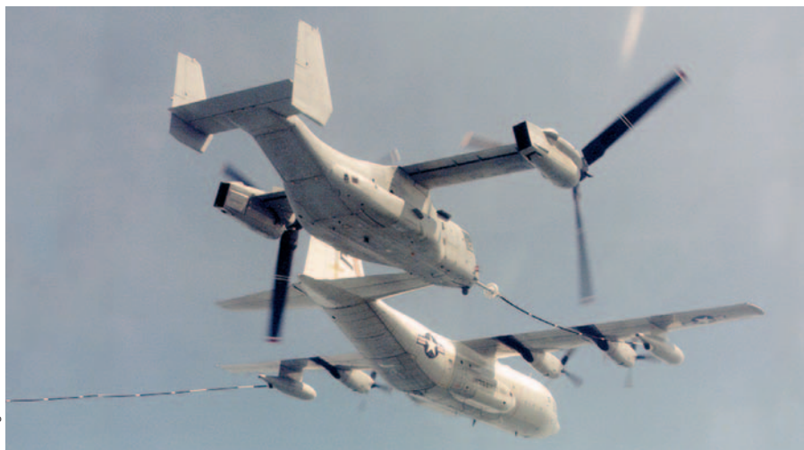
Вверху: отработка дозаправки конвертоплана «Оспри» от танкера KC-130 Внизу: в пилотской кабине «Оспри». На месте командира – начальник группы испытаний подполковник морской пехоты Кевин Гросс, на месте второго пилота – командир 3-го авиакрыла авиации КМП США генерал-майор Джим Эймос. Авиабаза ВМС США «Патуксент-Ривер», 9 января 2004 г.
