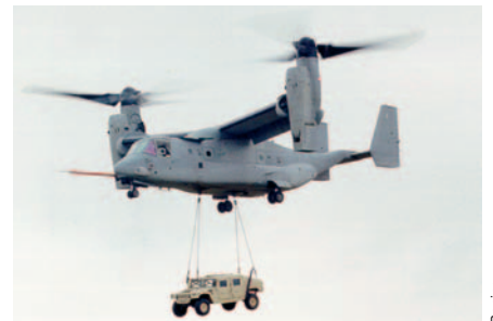
Опытный V-22 №08 в испытательном полете со стандартным армейским внедорожником «Хаммер» на внешней подвеске, август 1998 г.
