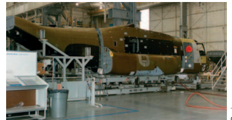
Внизу: сборка фюзеляжа V-22 №11 на заводе компании «Боинг» в Филадельфии
