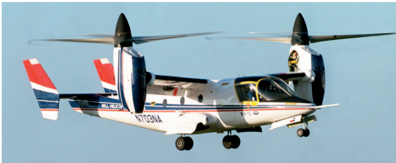
Непосредственный предшественник «Оспри» – опытный XV-15, созданный компанией «Белл» по программе TRRA в 1977 г. Два экземпляра этой машины за 26 лет испытаний налетали в общей сложности 1520 ч
